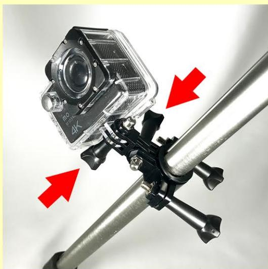
矢印で示しているネジを使い、前後左右の傾きを調節してください。
