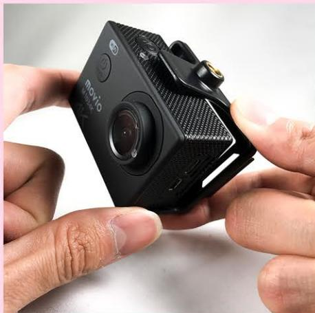
1. 写真のように枠が画面側、ツメがカメラ上部側になるようにはめ込みます。
