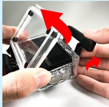
3. 背面側の留め具が浮くのでこれを上に外し、背面プレートを外します。
