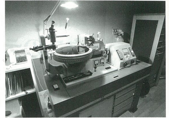
1970年代に製造されたノイマンのカッティングシステムVMS70を使用。モーターはデンオン製ACサーボDDに交換されている
