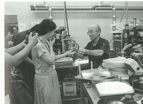
プレスしてすぐにレコード盤の外周バリ取りが自動で行われる。プレスしてすぐのバリはまだ温かく軟らかい、バリは材料としてリサイクルする
