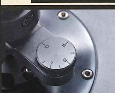
回転するレコードに針を落とした際、トーンアームには時計方向の回転モーメントが加わり、針先をレコードの内側音溝の壁に押しつける力が働く。これを取り消すために、外側に引っ張る力を機械的に与える機構。目盛りが刻んであり、カートリッジの適性針圧に合わせて設定する
