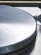
レコードを安定かつ水平に保ち、正しい回転で再生を行うための最重要部分。アルミやステンレスなどの金属が使われ、慣性モーメントによってフレににくく、さらに振動せずに回転するよう重さと固さが重要
