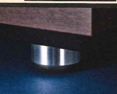
レコード再生に振動は禁物。振動によって「ハウリング」という不要ノイズが生じるからだ。インシュレーターは外部振動の抑制とともに、プレーヤー自身も共振しないように働く。水平維持用の高さ調節機構も内蔵
