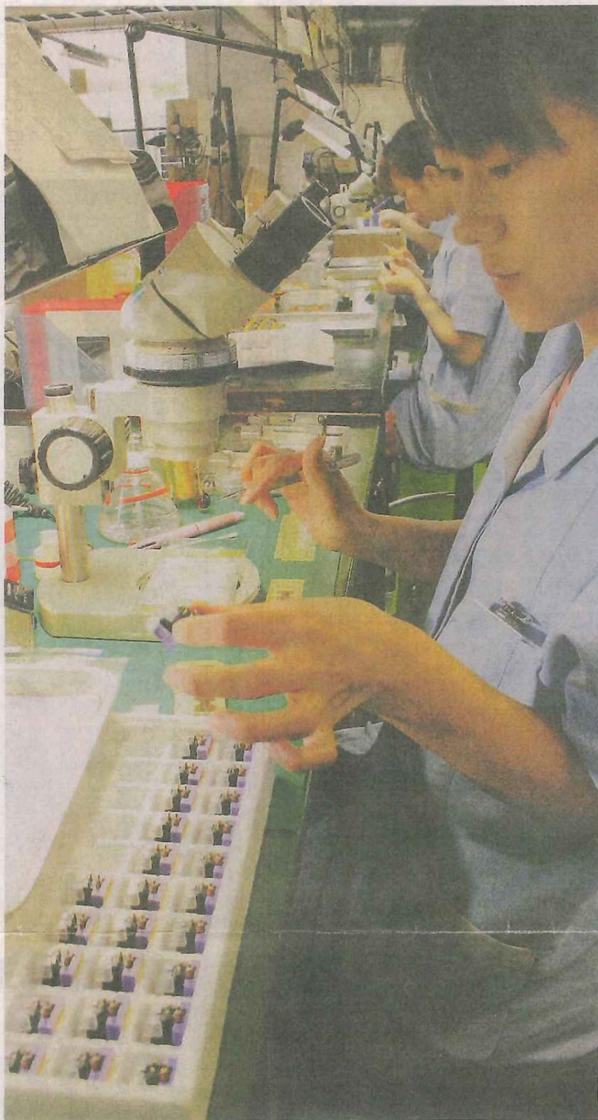
顕微鏡とピンセットを使った組み立て作業。熟練した技術と研ぎ澄まされた感覚が求められる＝東根市のナガオカ
