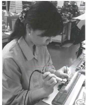
山形工場でのカートリッジの製造工程。MP-500の端子のハンダづけ工程
